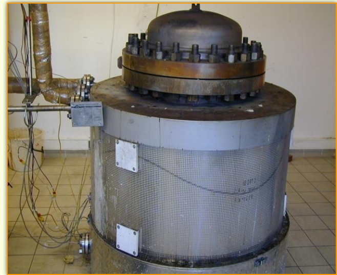
Reator piloto batch no Cirad (1MPa - 650°C)
