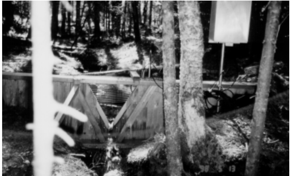
Vista do vertedor de uma das microbacias de monitoramento na Suécia. A área da microbacia acima deste ponto é de pouco mais de 30 hectares, ao longo dos quais existem dispositivos instalados para a medição de outras variáveis ambientais.
