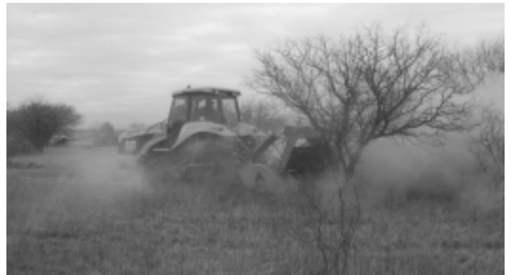
Desmatamento utilizando o UMH/DT-250 numa primeira passada. Utilizando-se o "braço" instalado no próprio equipamento a árvore é derrubada.
