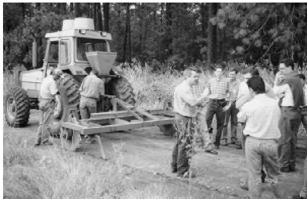
Participantes do evento durante a demonstração do protótipo de equipamento tratorizado de distribuição de isca formicida
