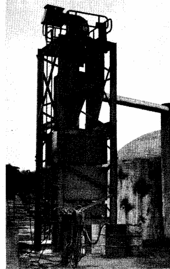
Recuperador de alcatrão em fornos de alvenaria
