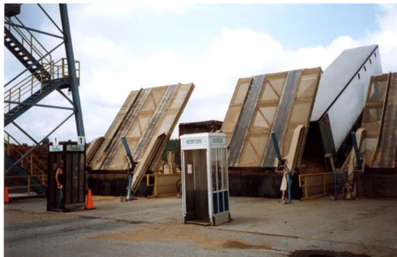
Figura 18. Elevação da plataforma e descarregamento dos cavacos.
