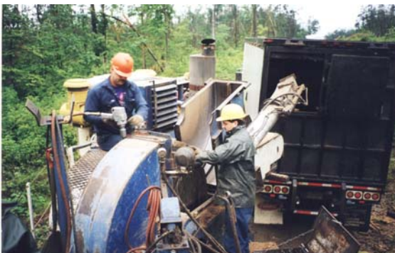
Figura 14. Processo de troca de facas (e) e disco com facas (d).
