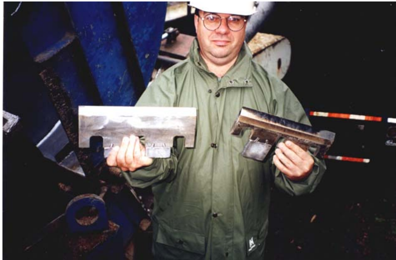
Figura 15. Faca nova (e) e faca com correção de profundidade (d).
