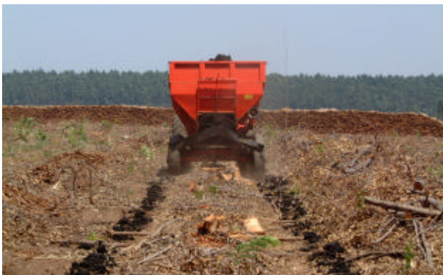
Foto 2 Aplicação de biossólido com 40% de umidade em área de corte raso através de carreta desenvolvida pela Cia. Suzano BahiaSul, em Itatinga-SP, Brasil.
