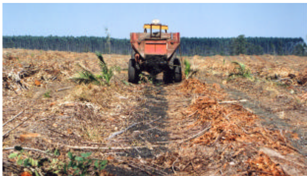
Foto 6 Aplicação de composto de lixo urbano, através de distribuidora de esterco, em área de corte raso de Eucalipto (Cia Suzano BahiaSul, em Itatinga-SP, Brasil).
