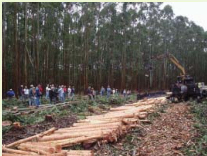
Operação de colheita mecanizada de eucalipto com Harvester
