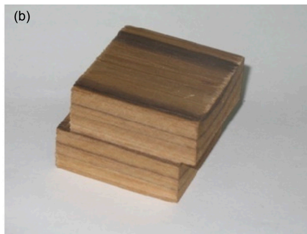
Figura 1. Esquema do corpo de prova segundo a ASTM D - 905 (2008a) (a) e confeccionado com a madeira de teca (b).
