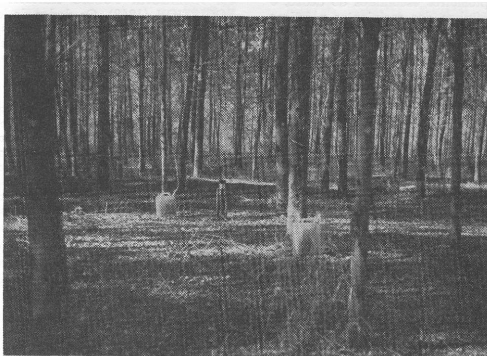
Figura 2: Vista interna do povoamento de eucalipto e dos dispositivos de medição da precipitação interna e do escoamento pelo tronco.
