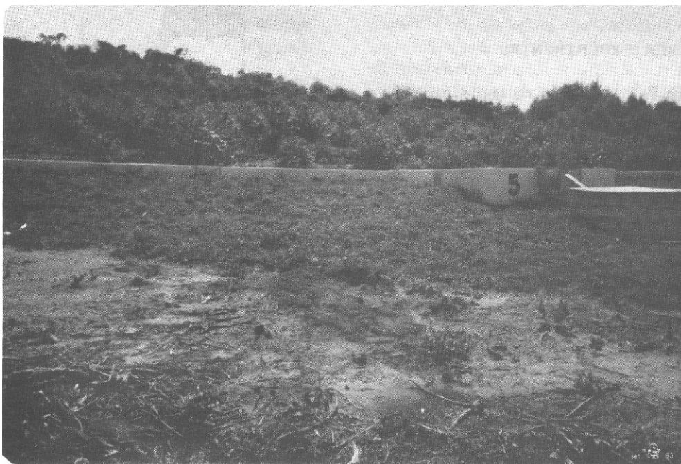
Figura 2 - Detalhe de uma das microparcelas coletoras de enxurrada e erosão.
