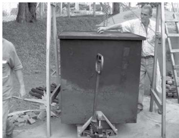
Figura 1. Detalhes da unidade de carvoejamento ou câmba metálica com tampa.
