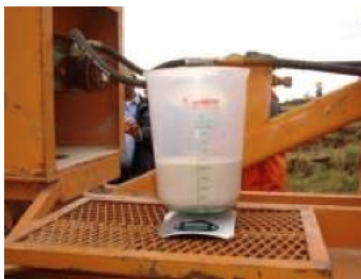
Figura 4 – Aferição da dose coletada em aplicação mecanizada (a) e manual (b)
