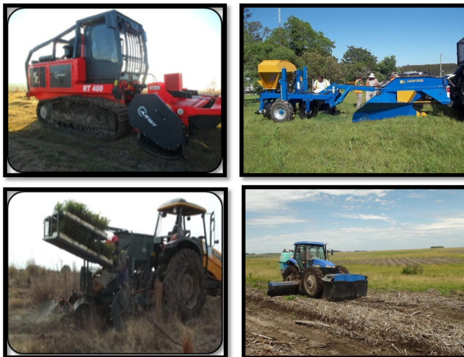
Figura 9- Triturador Ahwi 400 (a); 3 em 1, Despejador com disco y Subsulado + fertilización (b); Plantadora MdP, Plantación, Fertilización, Aplicación pre emergente y Aplicación gel (c); Tractor de alto despeje, aplicación de pre-emergente en la fila, y pós, en la entre fila (d);
