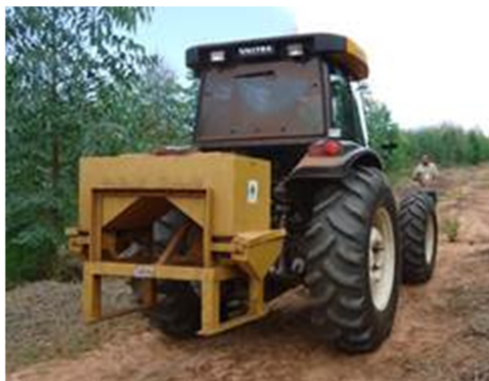
Figura 3 – Equipamento utilizado na aplicação de isca formicida.
