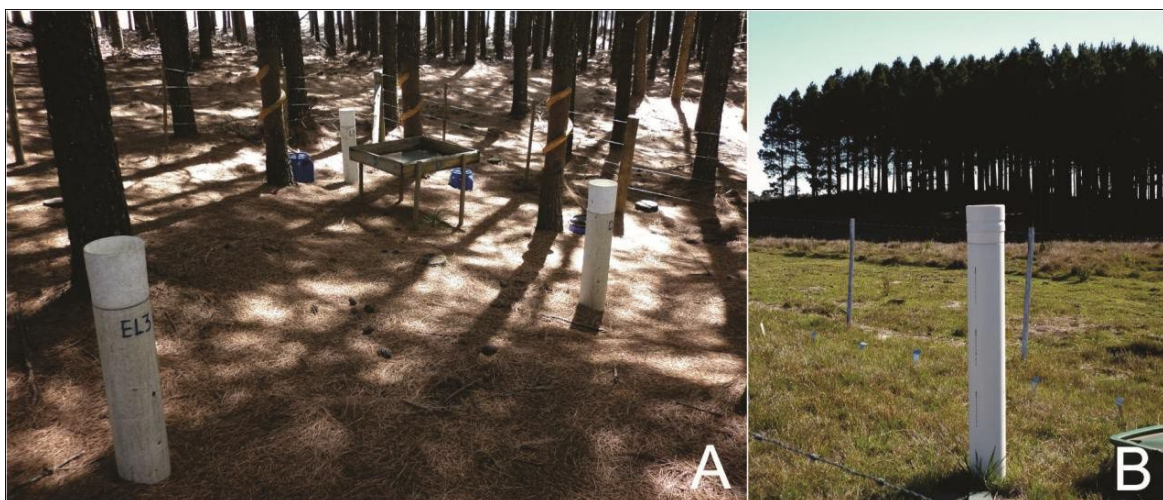
Figura 1 - Aspecto dos coletores da precipitação interna, instalados no povoamento de Pinus taeda L. (A); coletor da precipitação pluviométrica área de campo adjacente (B). Fonte: Lopes, 2013.
